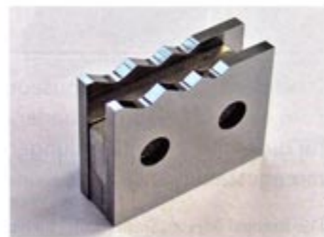
Die neue Leitz „Duo-Multiprofilziehklänge“ generiert eine perfekte Kantenoptik – ganz ohne Weißbruch und Rattermarken.
